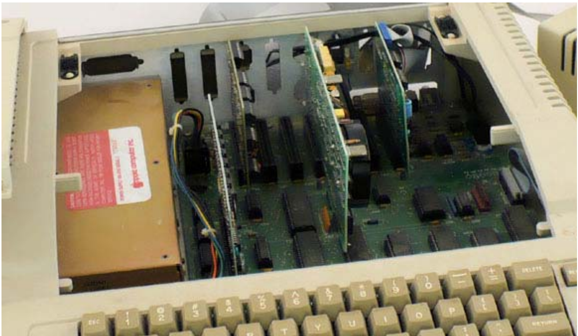
Apple II의 내부사진. 모든 Apple II기종은 Apple IIc시리즈에게 절약을 안겨준 사용 간편한 내장확장카드슬롯을 탑재.
